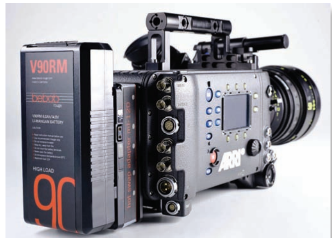
Литий-магниево-ионная батарея V 140 RM, установленная на камеру ARRI ALEXA через адаптер Vebob ML-120
